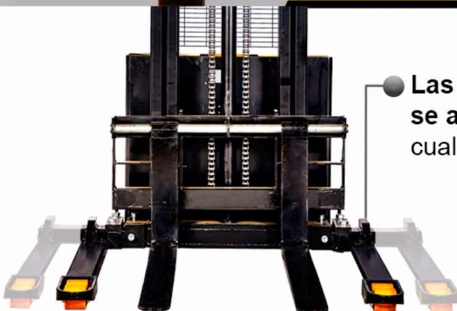
● Las patas estabilizadoras se ajustan para operar con cualquier tipo de tarima.
