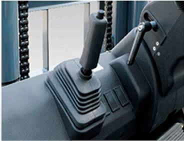
Freno de estacionamiento fácilmente ajustable.
